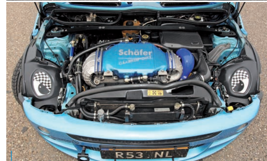
De intern grotendeels standaard gehouden 1.6 compressormotor zit met 255 pk behoorlijk aan zijn top zonder onbetrouwbaar te worden. De Gruppe M carbon airbox past als gegoten.
